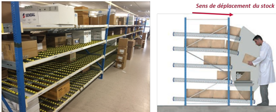
Photo et schéma du fonctionnement d'une étagère dynamique
