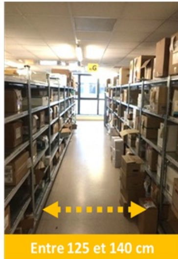
Rayonnages trop écartés avec des produits dans des cartons pour palier au manque de place
